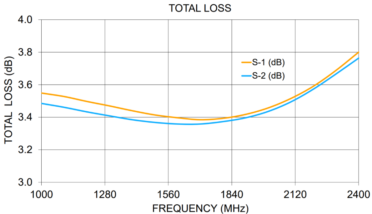
図3a : サムからポート1およびサムからポート2への挿入損失
